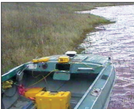
Измерительный комплекс на судне. Спутниковая система производства фирмы TRIMBLE NAVIGATION LIMITED (США)
