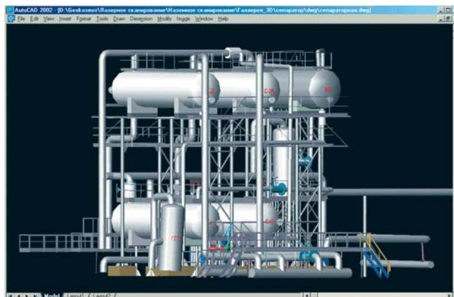
Трехмерная модель блока сепараторов ДНС-2 Западно-Сургутского месторождения ОАО «Сургутнефтегаз», выполненная НПП «Геокосмос» по результатам лазерного сканирования с использованием наземного лазерного сканера RIEGL LMS-Z210
